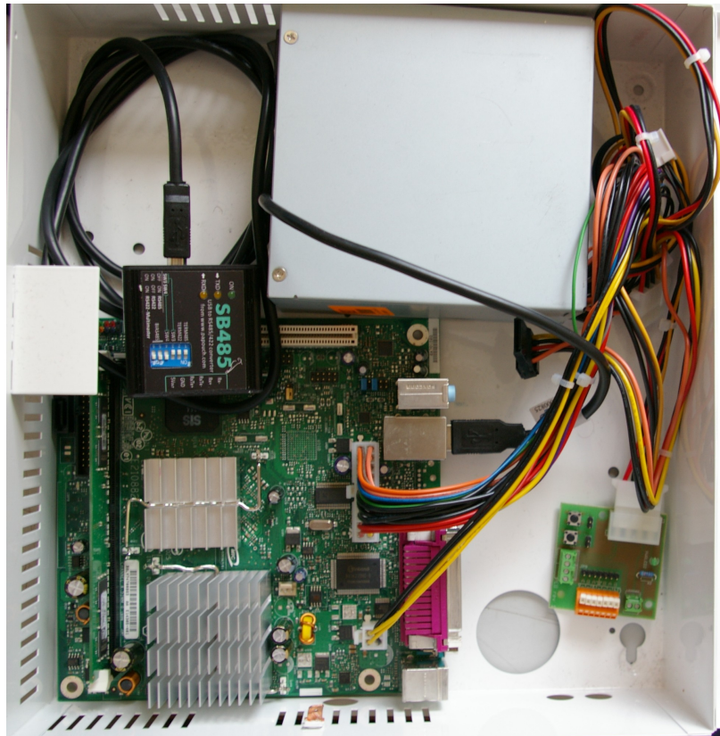
Obrázek 21: Rozmístění komponent v ZD3000 skříni
